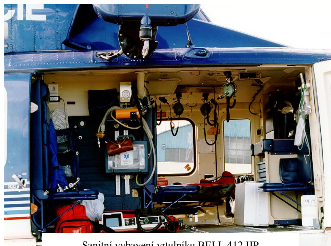
Sanitní vybavení vrtulníku BELL 412 HP
