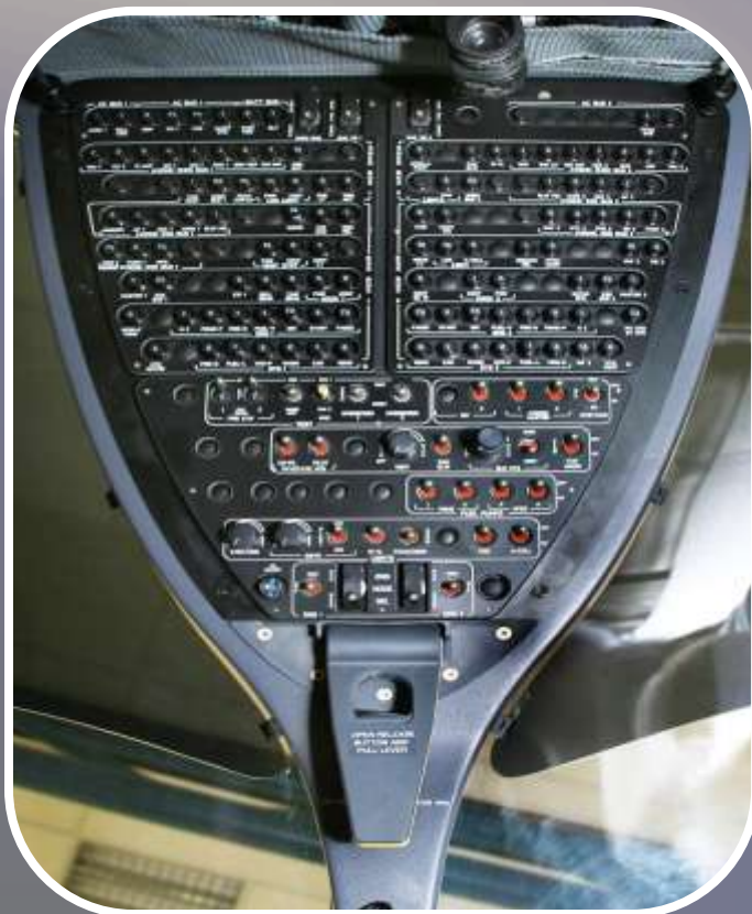
Stropní ovládací panel
