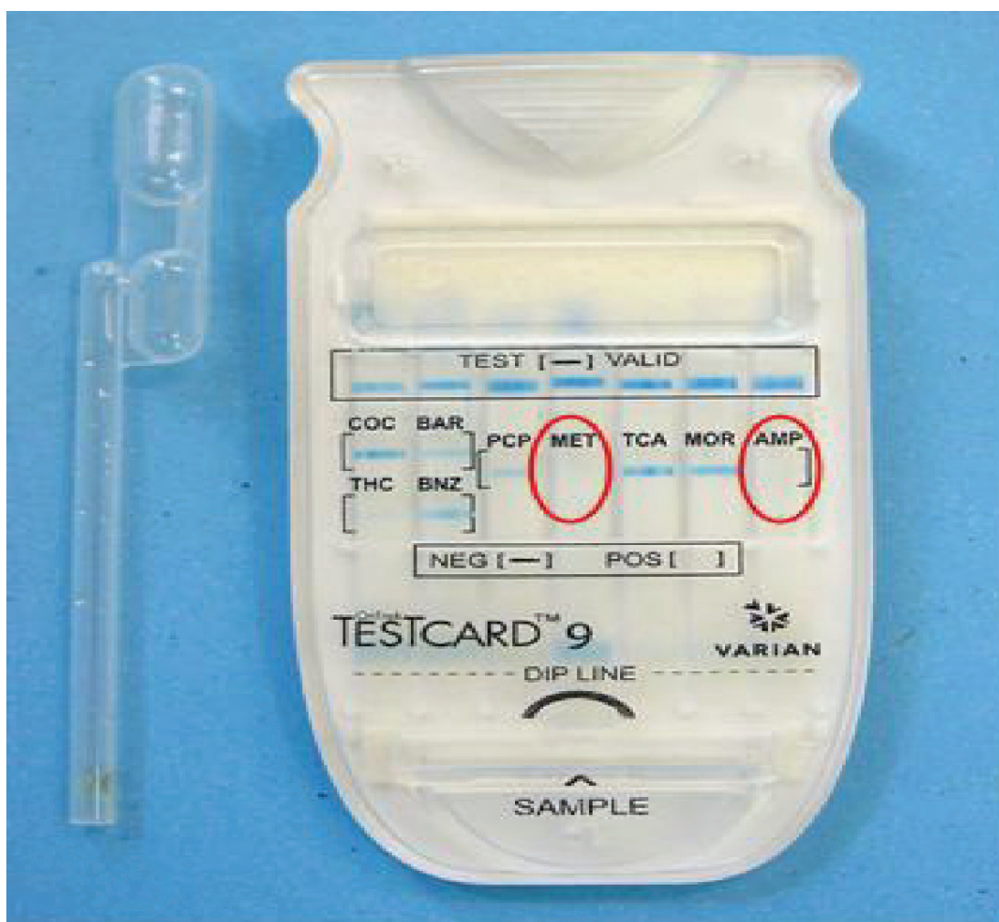
Obr. 1 TesTcard firmy Varian, diagnostický rychlotest určený pro kvalitativní analýzu drog v moči. Karta je dodávána s kapátkem, pomocí kterého je na kartu aplikováno potřebné množství vzorku. Výsledek je vyhodnocován vizuálně, v případě negativity je viditelný modrý proužek v dané oblasti, v případě positivity není proužek přítomen. Karta také obsahuje část nazvanou „test valid“, která je indikátorem platnosti zkoušky. Na zobrazenou kartu byla nanesena moč pacienta, vyhodnocením byla zjištěna přítomnost metamfetaminu a amfetaminu.
